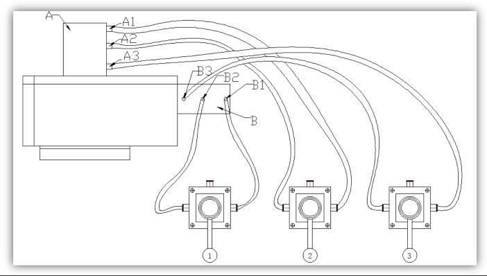
双气缸的接线方式:如图,气动式固定座由两个气缸组成,气缸A以及气缸B,每个气缸都有三个接口,前进接口(A1/B1)、后退接口(A2/B2)和解锁接口(A3/B3)
